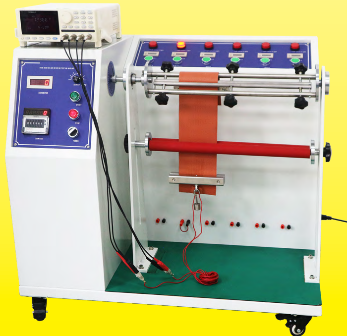
弯曲试验中的柔性硅胶加热器
